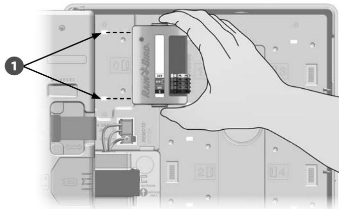
**2** Осторожно поместите модуль на заднюю панель контроллера сильно нажимая пока он не встанет на место. Красный сигнал на модуле начнет мигать, когда модуль правильно установлен. Если сигнал не мигает, проверьте установку модуля.
