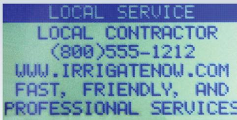
**Экранная справка местной службы** позволяет поставщику вводить специфические сообщения с именами и контактной информацией в контроллер через ПО с помощью USB-накопителя, что делает эту информацию видимой для домовладельца при нажатии кнопки «Помощь».
