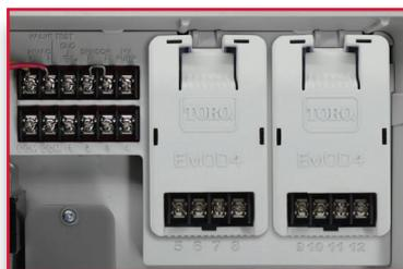
Конфигурация на 12 станций с модулями по (2) 4 станции
