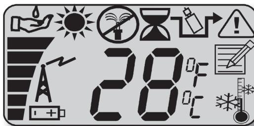
Предоставляет информативный отчет о системе, включая температуру наружного воздуха, силу сигнала передатчика и уровень заряда аккумулятора
