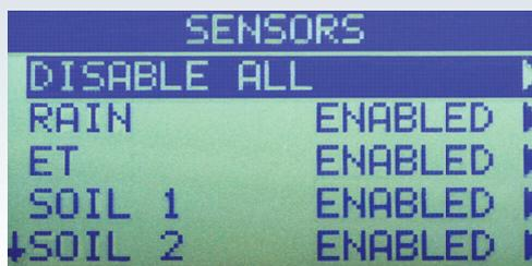
Например, **Экран применения датчиков** дает пользователю возможность просматривать и настраивать все доступные датчики, включая датчики дождя, ET и почвы.
