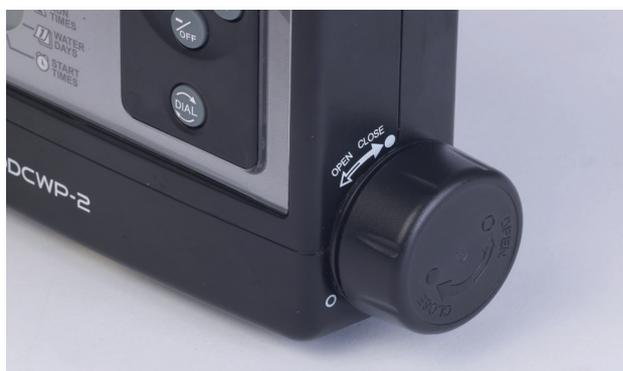
Для установки батареек достаточно открутить крышку. Крышка имеет герметичный уплотнитель, который предотвращает попадание воды внутрь отсека с батарейками. Степень защиты от попадания воды соответствует стандарту IP68 и дает возможность работать в воде на глубине до 2 м.
